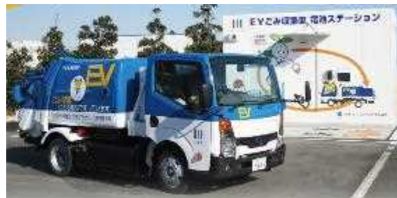
EVごみ収集車(電池交換型)と電池ステーション
